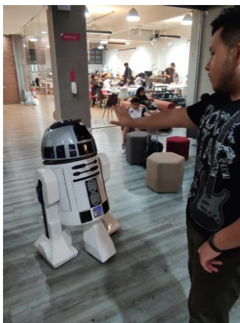
Figura 7 - Movimentação autônoma do robô para seguir através de comandos dados pela mão da pessoa
