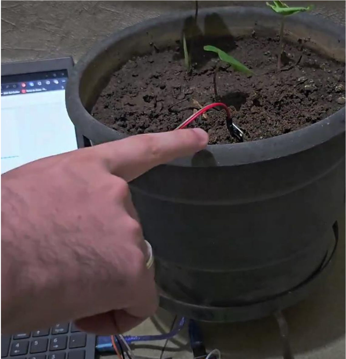
Imagem 3: Sensor de umidade conectado na terra
